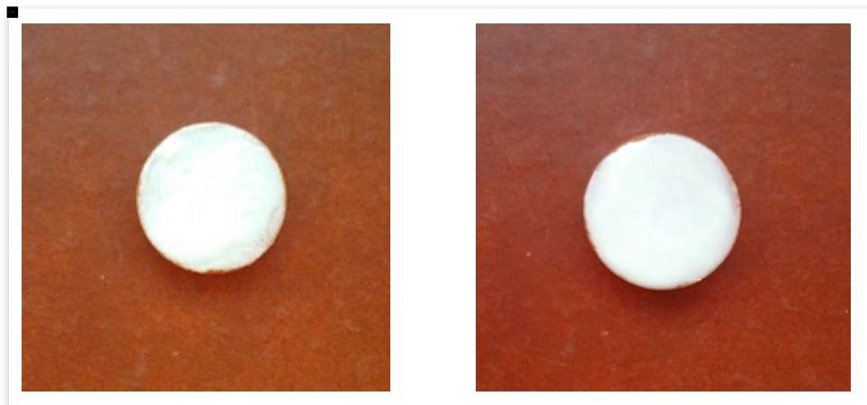
Figura 5: Probetas cerámicas esmaltadas y cocidas a 900°C y 1000°C respectivamente
